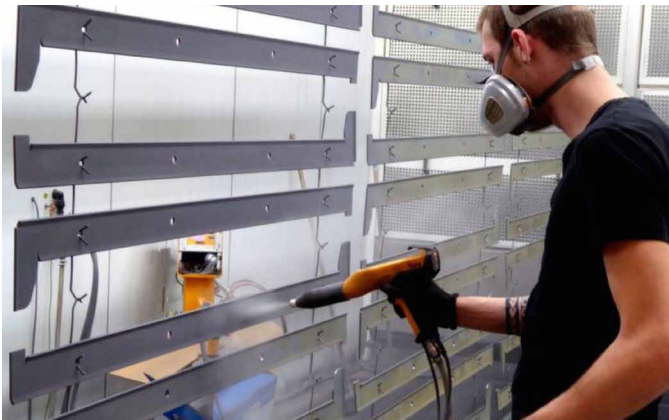
Aufbringen des Pulverlacks in der Pulverkabine. (Bild: MEEH)
