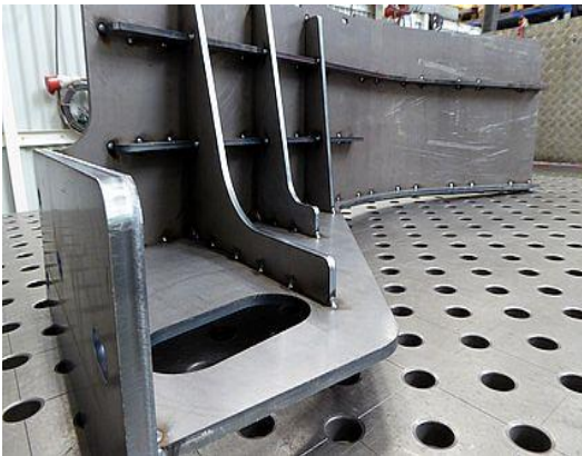
Typische Bauteile beziehungsweise Baugruppen der Seeger Lasertechnik: Mit dem Laser geschnitten, auf Abkantpressen gebogen und durch Schweißen gefügt. Bild: Kuhn
